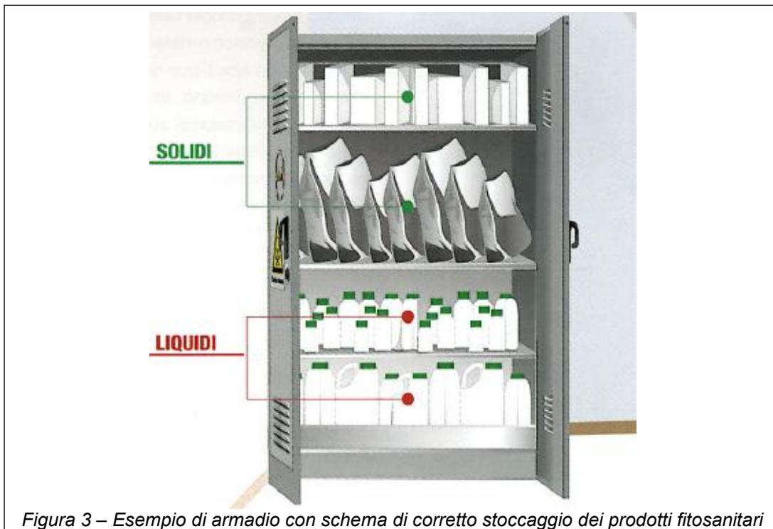
Figura 3 – Esempio di armadio con schema di corretto stoccaggio dei prodotti fitosanitari
